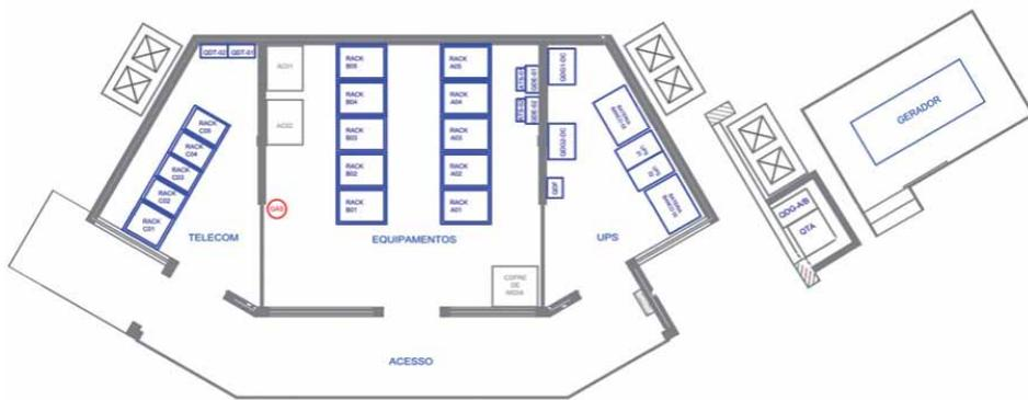
Planta baixa do Data Center, visão esquemática do Layout
