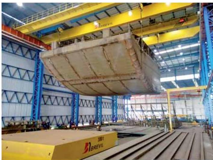
O primeiro método é chamado de “megabloços”, onde a embarcação é construída com apenas cinco blocos de costado a costado. Cada bloco tem um peso médio de 65 toneladas o que permite que na carreira 1 lancemos uma balsa de 2500 toneladas de DWT\* a cada 20 dias.
